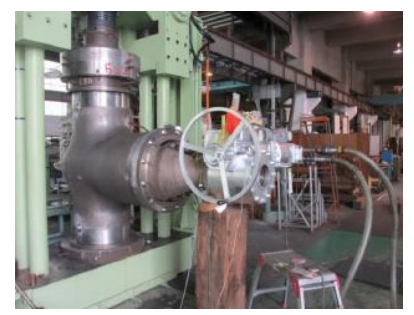
(電動弁の作動漏洩試験)
