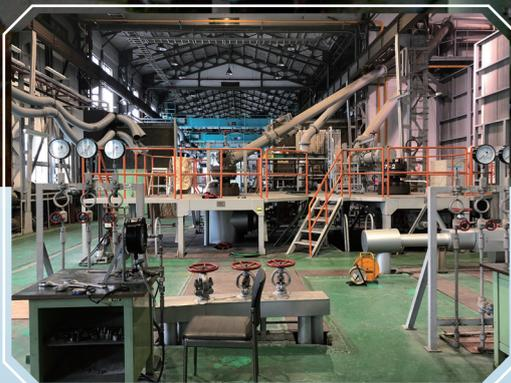
蒸気暴露試験
